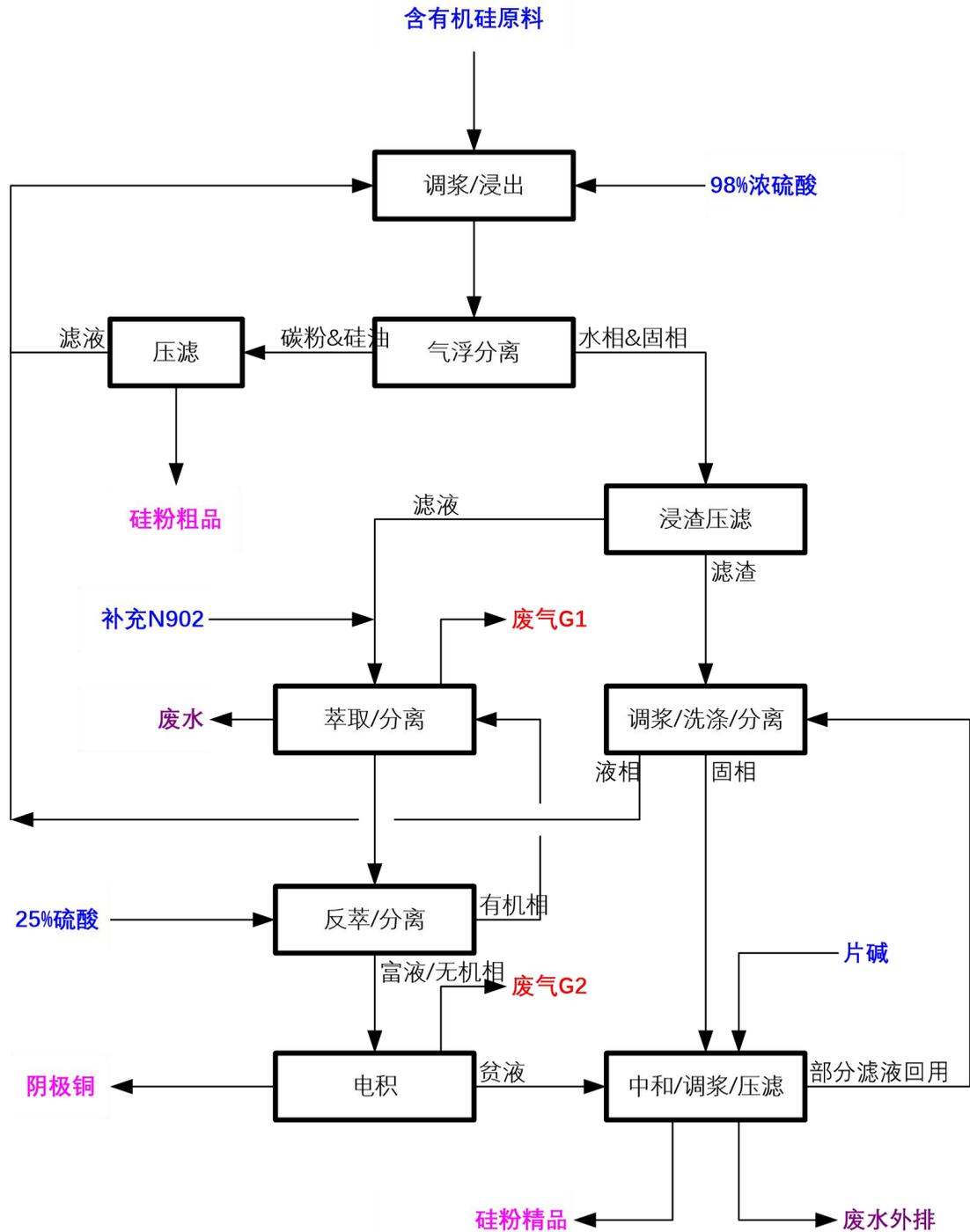
图 3-1 含铜硅粉处理工艺流程及产污环节示意图
