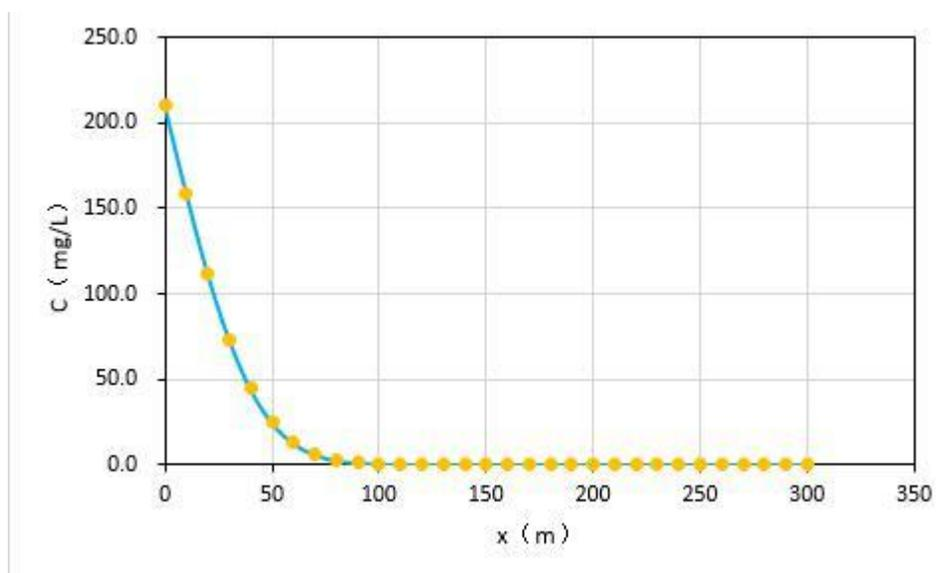
图 5.5-2 连续泄漏 1000 天铜污染扩散距离图
