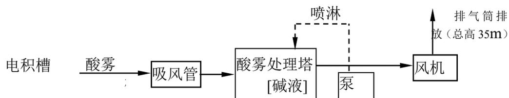
图 7.1-1 酸雾净化装置处理流程图
