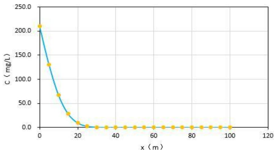
图 5.5-1 连续泄漏 100 天铜污染扩散距离图
