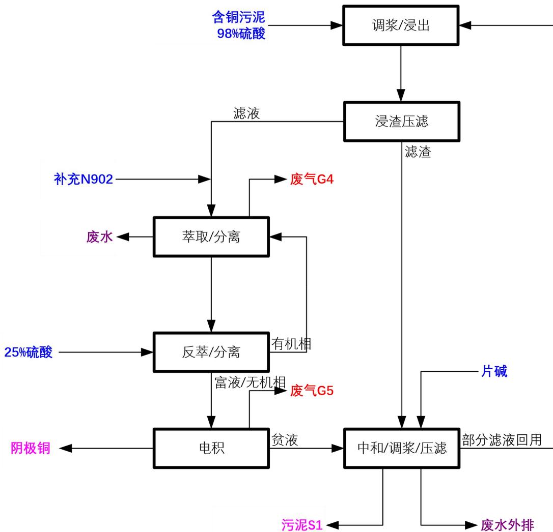
图 3-3 含铜污泥处理工艺流程及产污环节示意图
